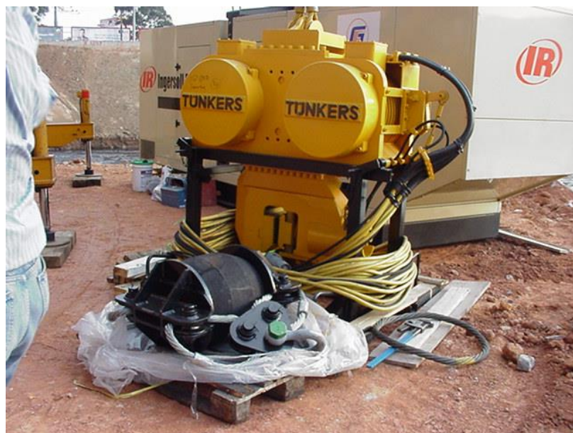
Figura 45 – Vibrador utilizado para cravar estacas-prancha no Rio Tietê. Fonte: Bernd Fröhlich.
