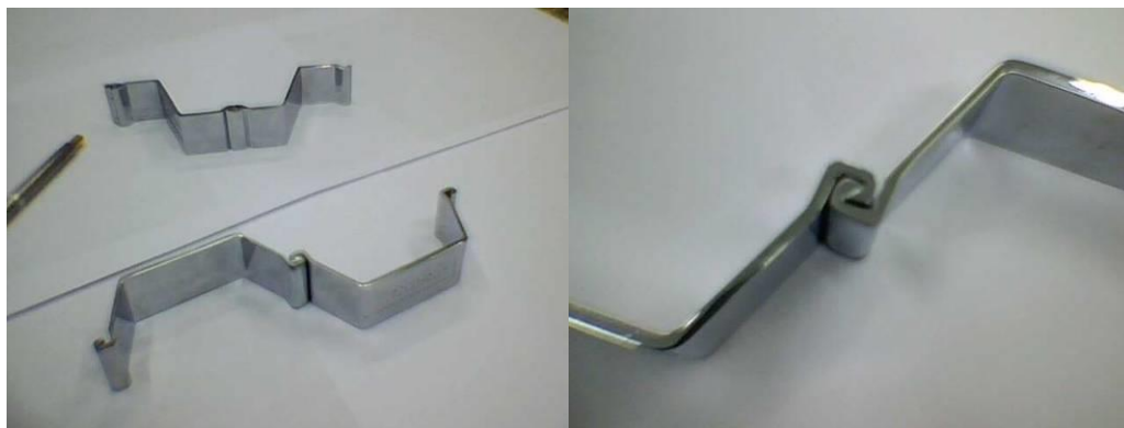
Figura 43: Miniaturas de estacas prancha metálicas nos formatos Z (superior) e U (inferior). Destaque para o detalhe do encaixe. Fonte: LPC-Latina
